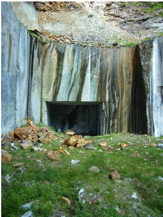
verlassener Serpentin-Steinbruch Ciampono im Val di Gressoney, ehemalige Gewinnungsarbeiten mit der Seilsäge
